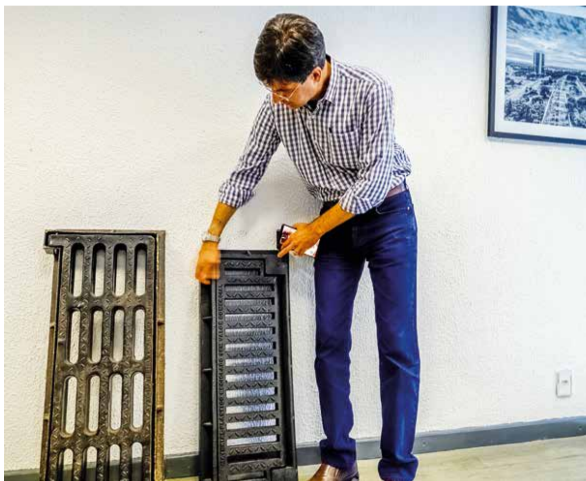
O modelo de grelha da esquerda, em ferro fundido nodular, passou a ser adotado pela Novacap como forma de inibir furtos e garantir mais segurança viária; o modelo da direita, em PVC de alta resistência, está sendo avaliado pela empresa
