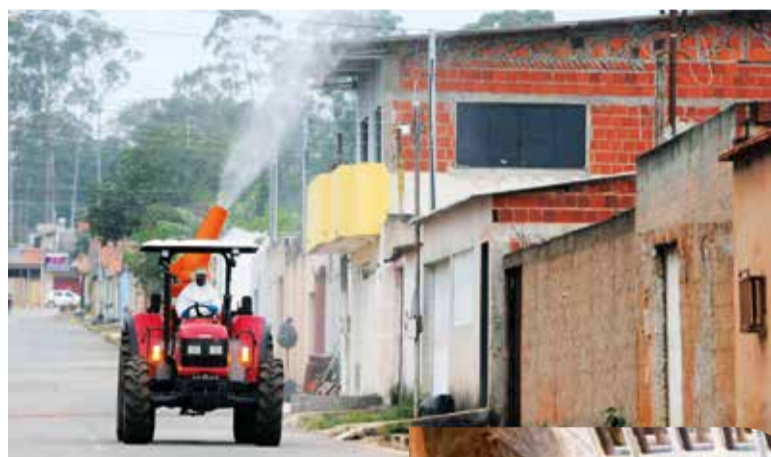
Equipamento de aplicação espacial de larvicida contra o Aedes aegypti , testado no final do ano passado, tem o alcance de pelo menos 60 metros
